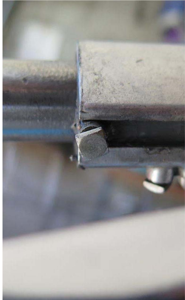
**ÉTAPE N°1** : débridage de la saignée droite ; limer à l'aide d'une petite lime ronde ou fraiser avec une petite fraise carbure ; cette modification permet une rotation plus importante de la poignée.
