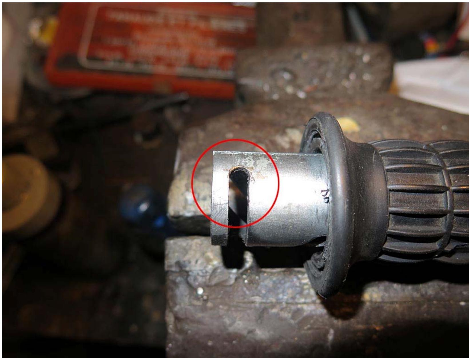
**ÉTAPE N°2** : débridage de la saignée hélicoïdale ; limer à l'aide d'une petite lime ronde ou fraiser avec une petite fraise carbure ; cette modification permet d'allonger la course du curseur (coulisse). Bien ébavurer pour ne pas usiner le curseur prématurément.
